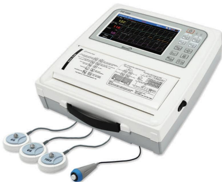
Специально разработанные водонепроницаемые зонды, использующие 9 кристаллов и частоту 1 МГц, значительно повышают надежность непрерывного мониторинга.
