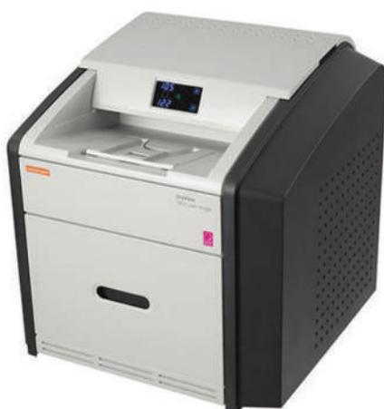
Dryview 5950 – современный лазерный медицинский принтер предназначен для печати изображений с высоким требованием к качеству. В мультиформатной камере DRYVIEW 5950 реализована новейшая технология «сухого» фототермографического проявления. Принтер CARESTREAM DryView 5950 позволяет печатать маммографические снимки без дополнительной установки программного обеспечения.
