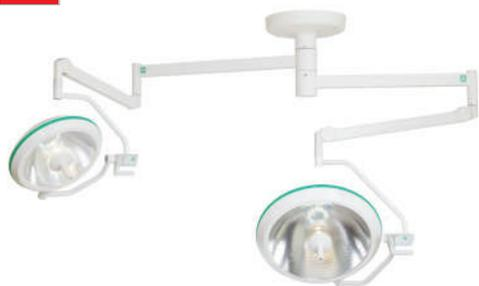
Серия операционных галогенных светильников Аксима - это высокая надежность и отличные эргономические показатели. Бестеновой эффект и «холодный свет» достигается с помощью мультизеркального отражателя и ИК-фильтра. Каждый осветительный блок имеет функцию автоматического переключения на резервную лампу в случае выхода из строя основной лампы. Для обеспечения бесперебойной работы в случае неисправности в сетевом питании светильник может быть оснащен блоком аварийного питания.
